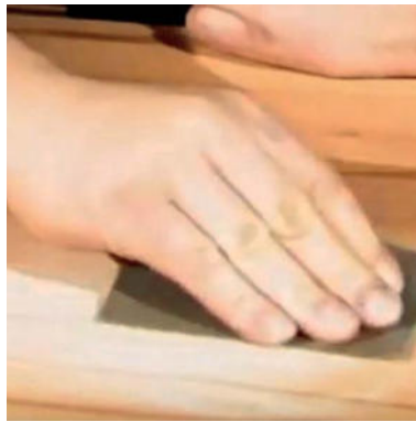
in Faserrichtung ausschleifen
