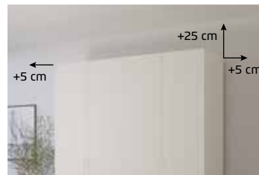
Für die Montage des Schrankes wird folgender Platz benötigt: Schrankhöhe + mind. 25 cm, Schrankbreite + mind. je 5 cm an beiden Seiten.
